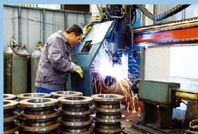
松下自动焊接 Panasonic automatic welding
